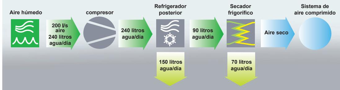
Un compresor que suministra 200 litros/segundo de aire también aporta unos 10 litros/hora de agua cuando comprime el aire a 20°C. Los problemas debido a la precipitación de agua en las tuberías y los equipos se pueden evitar con un refrigerador posterior y un secador.
