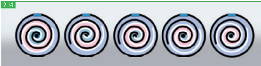
Principio de compresión de un compresor scroll.
